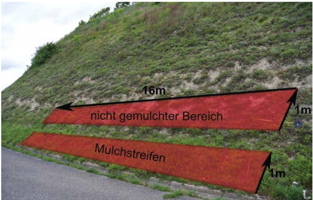
Abbildung 4: Schematische Darstellung der Aufnahmeflächen im Mulchstreifen und nicht gemulchten Bereich. Foto: Mira Büll
